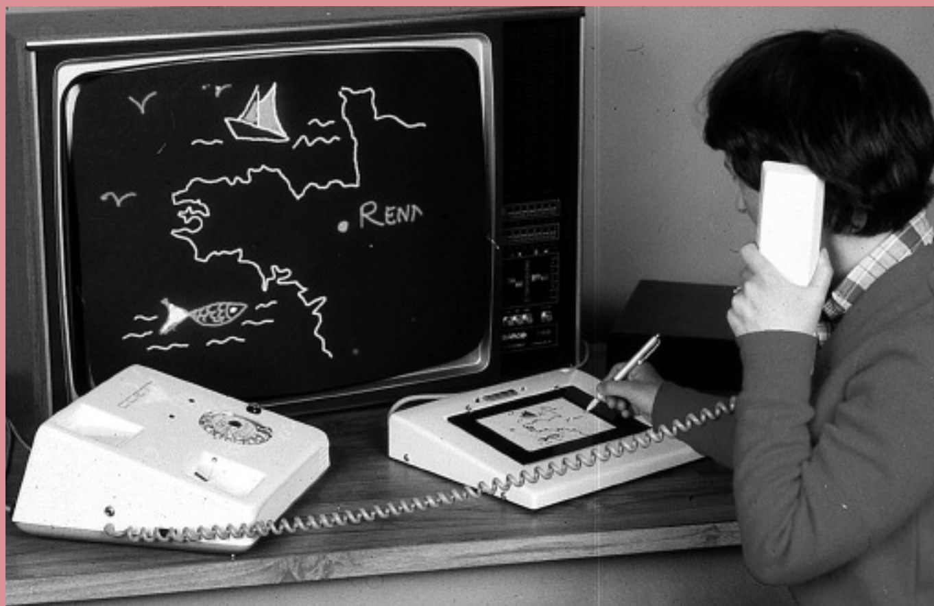
La téléécriture avec possibilité de dessins est expérimentée à Rennes dès 1978.
